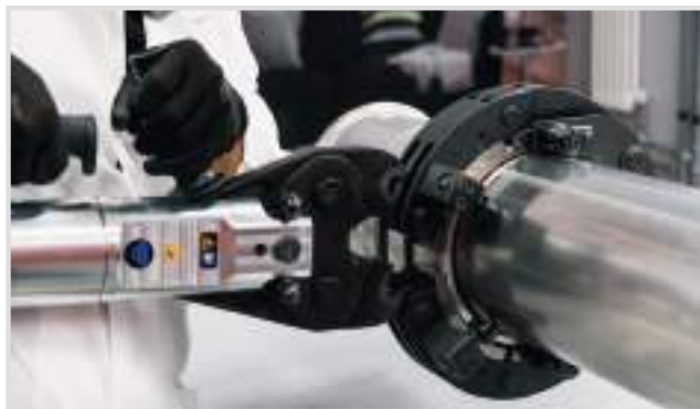
Assemblaggio pressatura n°1 / Press assembly phase 1
